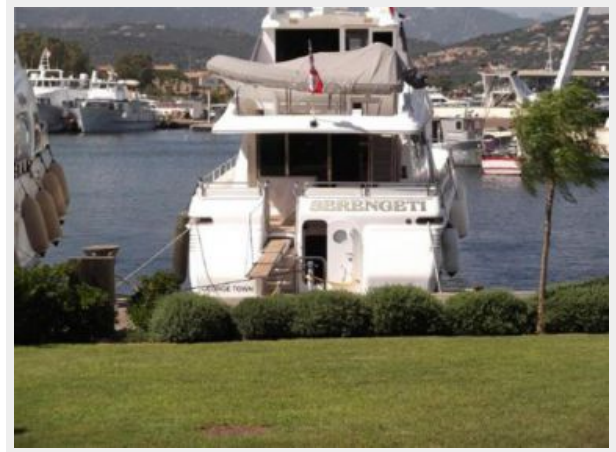
Med Mooring Passerelle
