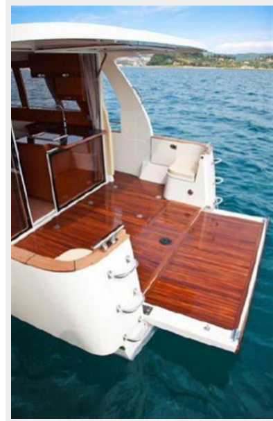
Transom door down
