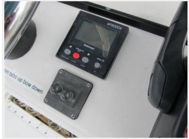
Auto pilot/Trim Tab switches
