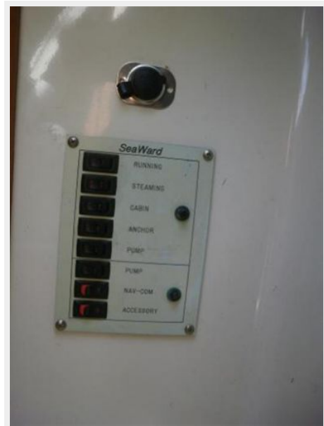
Primary 12 Volt Panel plus 12Volt Outlet
