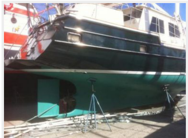
Protected Rudder - keel
