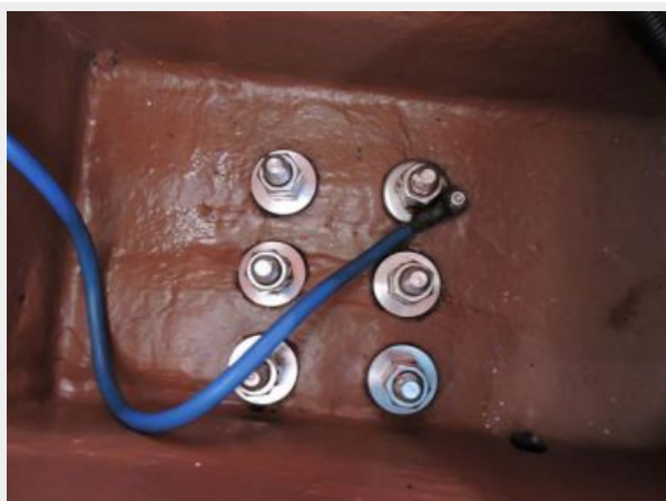
Bavaria 49 Keel bolts
