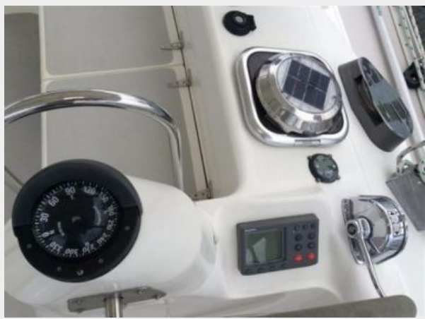
Raymarine Autopilot & Solar Vent
