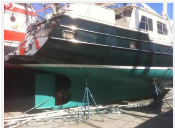
Protected Rudder - keel
