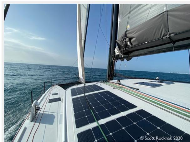
HH50 Solar Array
