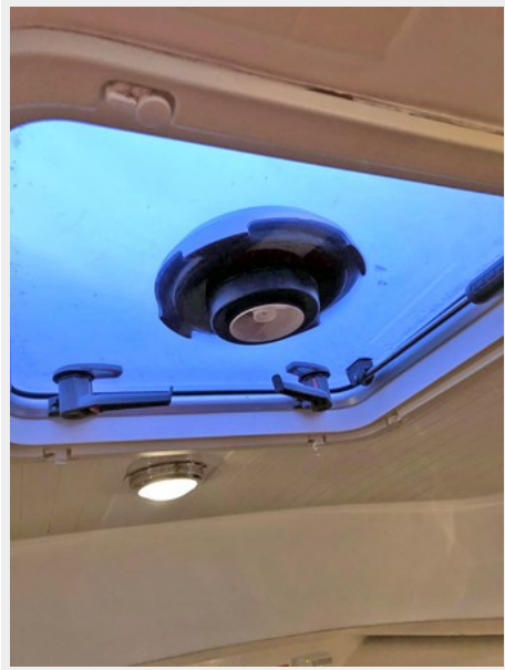
New Solar Vent w Fan
